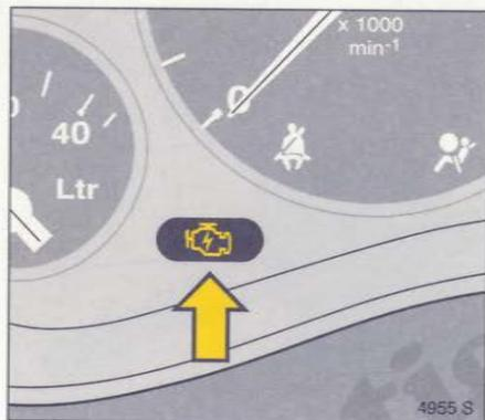
Bei eingeschalteter Zündung leuchtet die Kontrollleuchte für Motorelektronik kurze Zeit. Blinkt sie bei eingeschalteter Zündung, liegt eine Störung im System vor, der Motor kann nicht angelassen werden:
