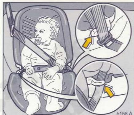
Höhenverstellung \* des Fahrzeug-Sicherheitsgurtes auf niedrigste Position einstellen.
