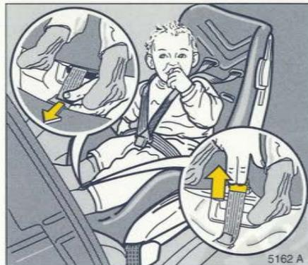
Zur Längeneinstellung Gurtband vorn an Kindersicherheitssitz ziehen bzw. durch Anheben der Metallasche lockern.
